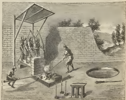
Fig. 4. Hogar desmontable de herreros ambulantes
